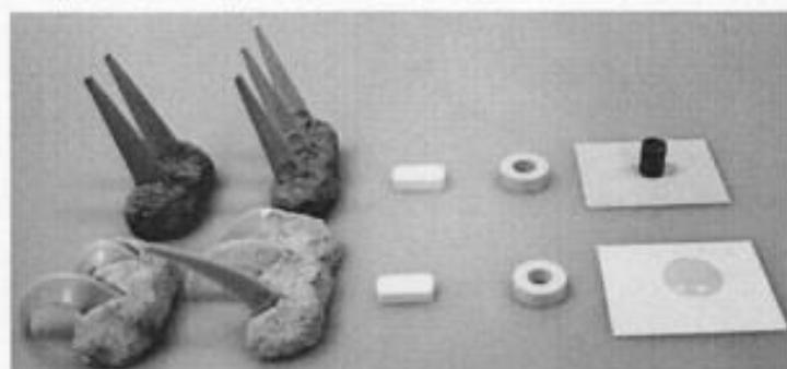
図2 焼成チップの比較（奥：焼成前 前：焼成後）
