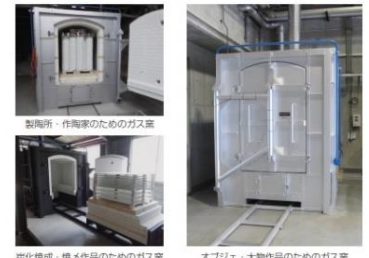
上下温度差を非常に少なくした陶芸用ガス窯。 温度ムラが少なく、焼成コントロールが容易にできる。 また、オブジェの様な大きな作品を入られる高さにするなど、使用目的に応じた設計が可能 (0.2m 2 )。
