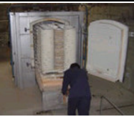
1991年12月完成の2.0㎡ガス窯(本焼き用) 台車2台で交互に焼成できるトラパーサー式を採用、大物や大量注文に対応しています。また、炭化焼成が出来るのも大きな特徴です。もともとこの場所にはT社の古い4㎡のガス窯がありました。これを弊社で解体して新たに築窯しました。
