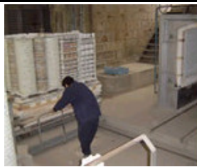
1991年12月完成の2.0㎡ガス窯(本焼き用) 台車2台で交互に焼成できるトラパーサー式を採用、大物や大量注文に対応しています。また、炭化焼成が出来るのも大きな特徴です。もともとこの場所にはT社の古い4㎡のガス窯がありました。これを弊社で解体して新たに築窯しました。
