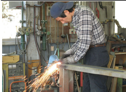
プラズマ切断機で鋼材の加工作業
